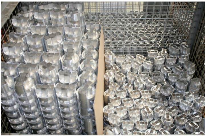
Geschmiedete Rohlinge, fertig zur Weiterverarbeitung
