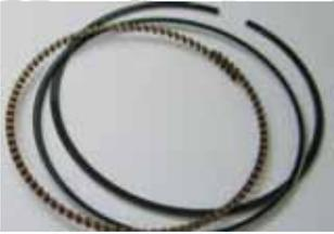
Achtung: Verchromte Ringe dürfen nicht in verchromten Bohrungen eingesetzt werden. Sie können in Guss-, aus Bor-Verbundwerkstoffen hergestellten, sowie Nikasil® und Plasmabeschichteten Zylinder eingesetzt werden.
